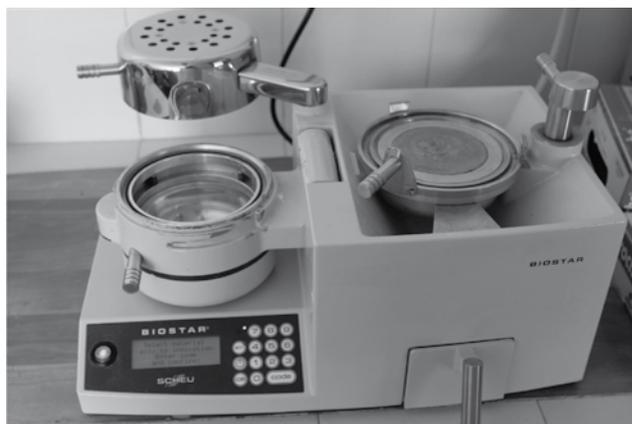
Рисунок 8 – Аппарат «Биостар» для обжатия преформированной нёбной пластины на модели
