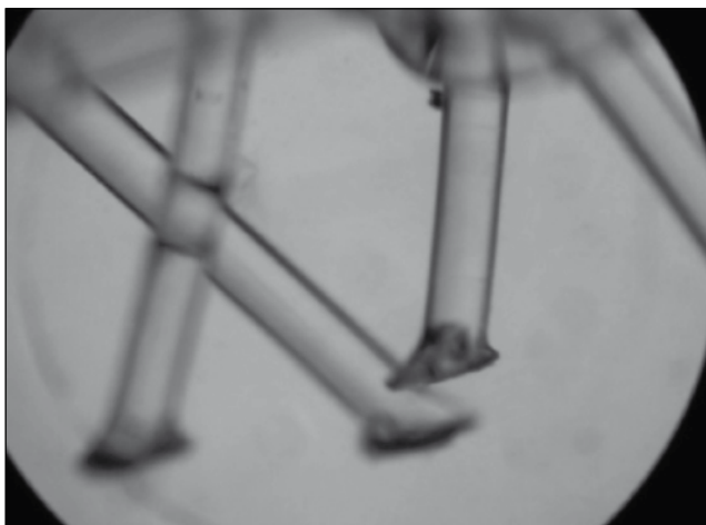
Рисунок 1 – Микрофото. Линия среза имплантата стандартными хирургическими ножницами. Увеличение 10x10
